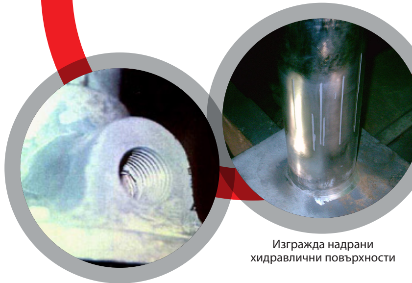
Формоване на изтръгнати резби
